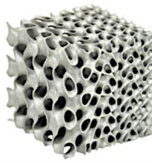
Gradiran TPMS celični metamaterial
