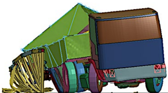
Računalniška simulacija naleta 38-tonskega tovornjaka na cestno varnostno ograjo
