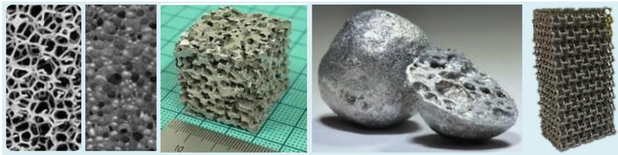
Slika 2. Izbrane celične strukture, vsestransko analizirane v raziskovalnem programu: odprtocelična pena; zaprtocelična pena; aluminijeva pena, pridobljena z infiltracijskim litjem; element napredne morfologije por (NMP); avksetična celična struktura
